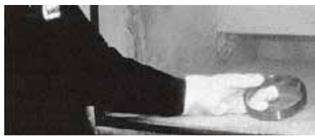
恒温控制的冷却装置有助于将紧配合的圆锥外圈安装到轮毂上。
