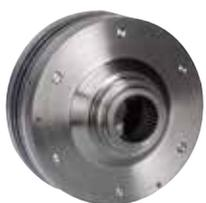
TLC限矩器设计旨在消除冲击载荷。它能吸收转子的动能，并通过打滑来保持设置好的扭矩值。我们限矩器的专利设计使得扭矩设定值可以防止篡改，并消除了因人工误调而造成的问题。
