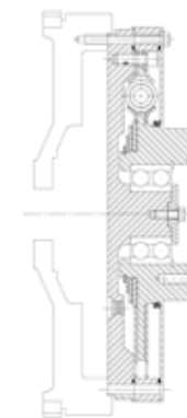
引擎独立式安装 远程驱动轴安装 (带密封和自润滑)
