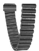
皮带两侧均可实现久经考验的性能,让你的传动设计更加灵活而高效。联合工艺将上下齿结合成了一条上下两侧均具有100%额定功率的均质皮带。两个齿面都有包覆织物。
