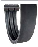
Super Vee-Band联组带十分适用于传统的三角皮带传动装置。在这类传动装置中,由于载荷条件的波动或传动装置的严重振动,单条皮带往往会翻转或严重振动。Super Vee-Band联组带的每个峰在顶部处通过加强的织物贴层被永久地连接在一起。Super Vee-Band还具有耐油、耐热以及静电耗散性等特点。
