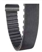
ACHE皮带专为风冷式热交换器而设计。这款皮带仅采用"Z"捻张力线。这会导致皮带向上移动,有助于使皮带不接触底部法兰盘,从而减少皮带底侧的过度磨损。
