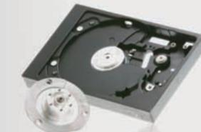
简介: 拥有流体轴承的电机, 完美实现硬盘高负载和高速读写的需求。
