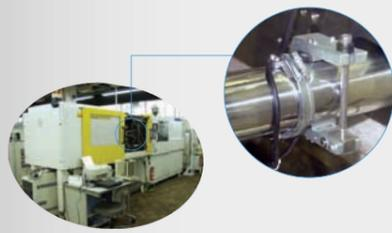
简介: 采用应变计的张力计, 通过安装在拉杆上实现锁模力和开模力的测量。
