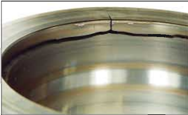
照片6-3 ● 双列圆柱滚子轴承的外圈。 ● 以滚道面上的剥落为起点，沿轴向与圆周方向产生的裂缝。 ● 由冲击压痕造成的剥落发展所致。
