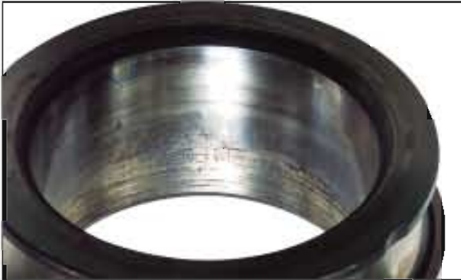
照片13-1 ● 调心滚子轴承的内圈。 ● 内径面上的蠕变，伴随有擦伤。 ● 因过盈量不足而造成的。
