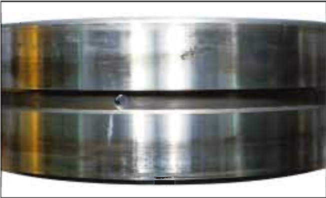
照片13-2 ● 调心滚子轴承的外圈。 ● 外径面上整周的蠕变。 ● 由外圈和轴承座的间隙配合造成的。
