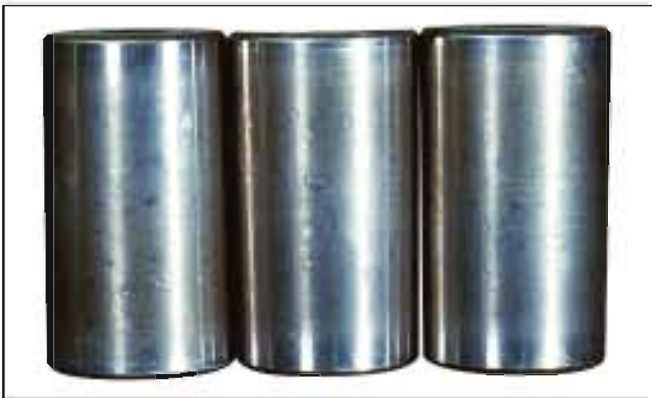
照片8-4 ●照片8-3的圆锥滚子。 ●整个滚动面上产生了无数大小不等的压痕。 ●由于异物侵入造成的。
