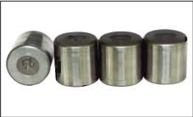
照片17-3 ● 圆柱滚子轴承的滚子。 ● 滚动面上产生的轴向伤痕。 ● 安装时内、外圈倾斜造成的。
