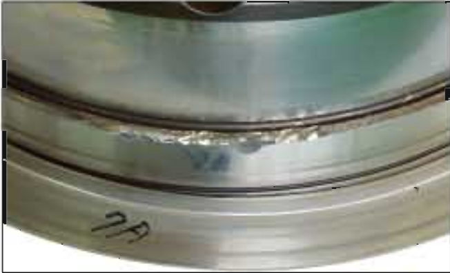
照片5-1 ● 双列圆柱滚子轴承的内圈。 ● 中挡边上的破裂。 ● 由安装时的过大载荷造成。
