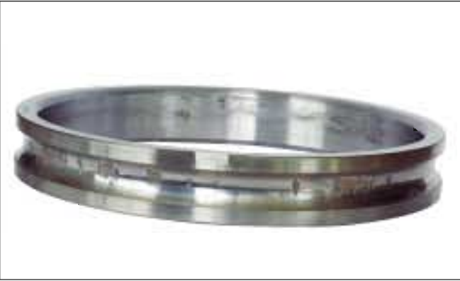
照片 1-4 ● 角接触球轴承的内圈。 ● 沟道面上产生呈等球距分布的剥落。 ● 由停机时冲击载荷造成的压痕发展成。
