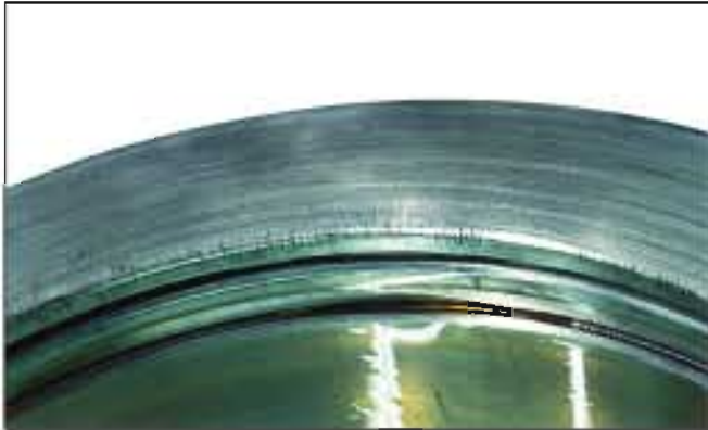
照片6-1 ● 双列圆柱滚子轴承的外圈。 ● 外圈端面上的热裂纹。 ● 原因是外圈面与相配零件的接触打滑造成的异常发热。
