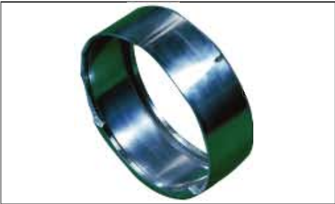
照片5-4 ● 实体滚针轴承的外圈。 ● 外圈挡边上的破裂。 ● 原因是承受过大载荷导致滚子歪斜。
