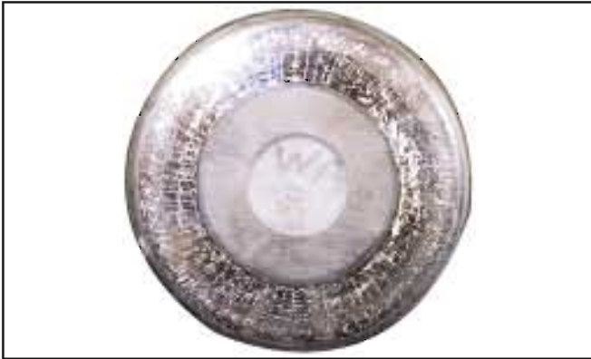
照片6-2 ● 推力圆锥滚子轴承的滚子。 ● 滚子大端面上的热裂纹。 ● 原因是润滑不良使滚子端面与内圈挡边打滑造成的异常发热。
