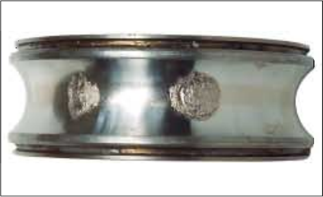
照片1-3 ● 深沟球轴承的内圈。 ● 沟道面上产生呈等球距分布的剥落。 ● 由安装时冲击载荷造成的压痕发展成
