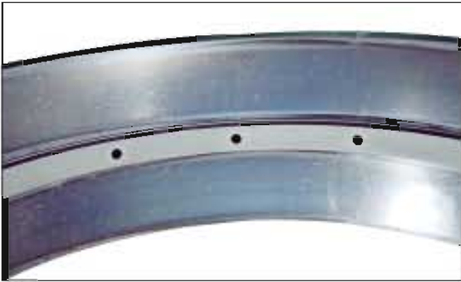
照片8-2 ●双列圆锥滚子轴承的外圈。 ●滚道面上产生了无数微小压痕。 ●由于异物侵入造成的。
