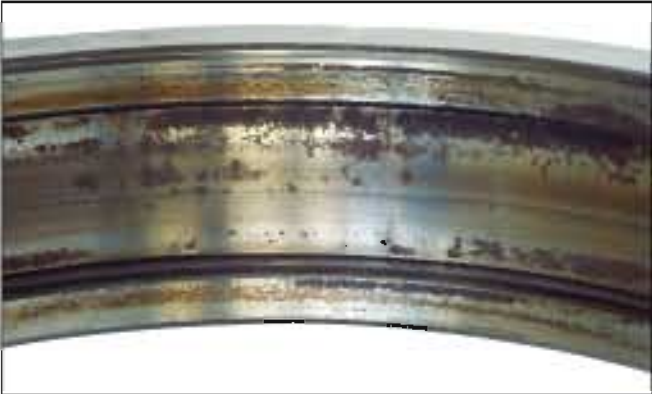
照片16-1 ●圆柱滚子轴承的外圈。 ●滚道面及挡边上生锈。 ●原因是由于进水造成润滑不良。
