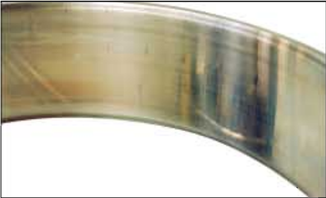
照片17-2 ● 双列圆柱滚子轴承的外圈。 ● 整个滚道面上均有呈滚动体间距分布的线状伤痕。 ● 安装时内、外圈倾斜造成的。
