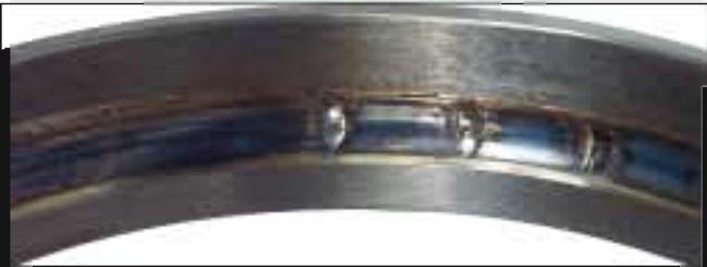
照片14-4 ● 照片14-3的外圈。 ● 滚道面变色，出现呈等球距分布的熔融痕迹。 ● 预紧过大造成的损伤。
