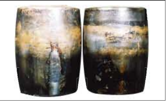
照片14-2 ● 照片14-1的球面滚子。 ● 滚子滚动面变色，保持架磨损粉末熔融后被碾轧，附着。 ● 润滑不良造成的损伤。
