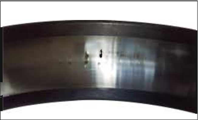
照片12-2 ● 照片12-1的外圈。 ● 滚道面上的伪布氏压痕。 ● 停机时由外部振动造成的损伤。
