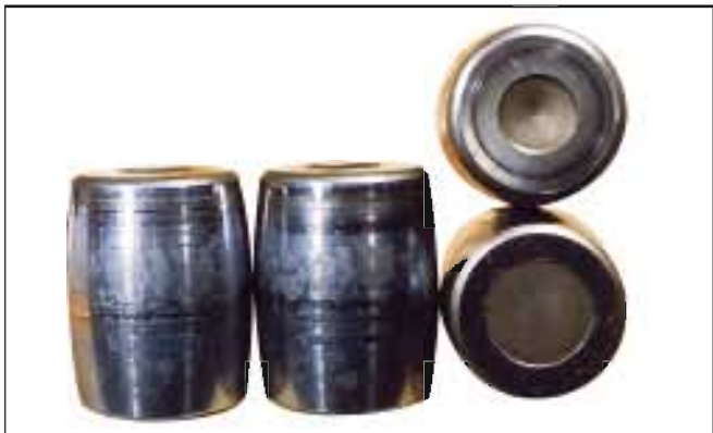
照片2-3 ●照片2-1的球面滚子。 ●滚动面中央的圆形花纹状剥皮。 ●润滑不良造成的损伤。
