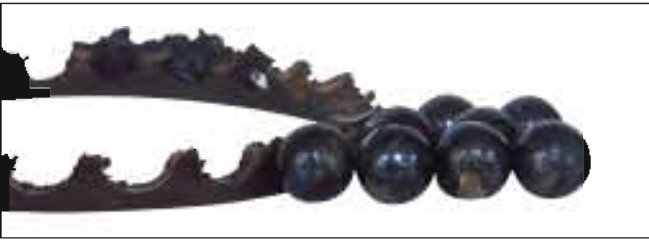
照片14-5 ● 照片14-3的保持架、球。 ● 保持架熔融，破损，钢球变色，熔融。 ● 预紧过大造成的损伤
