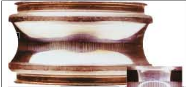
照片15-5 ●深沟球轴承的内圈。 ●滚道面上的条纹状电蚀（高频）。
