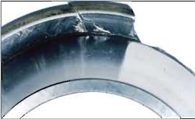
照片5-3 ● 推力调心滚子轴承的内圈。 ● 大挡边上的破裂。 ● 由循环载荷造成。
