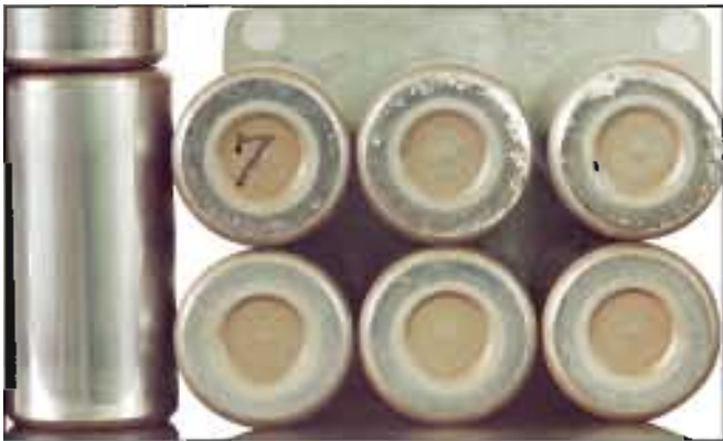
照片3-4 ●双列圆柱滚子轴承的滚子。 ●滚子端面上的擦伤。 ●润滑不良，轴向载荷过大造成的损伤。
