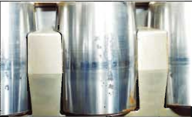
照片16-4 ●调心滚子轴承的滚子。 ●滚道面上产生的凹坑状锈蚀。 ●保管过程中水分凝结造成的。
