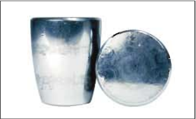
照片3-6 ●照片3-5的球面滚子。 ●滚子端面上的擦伤。 ●异物侵入，轴向载荷过大造成的损伤。
