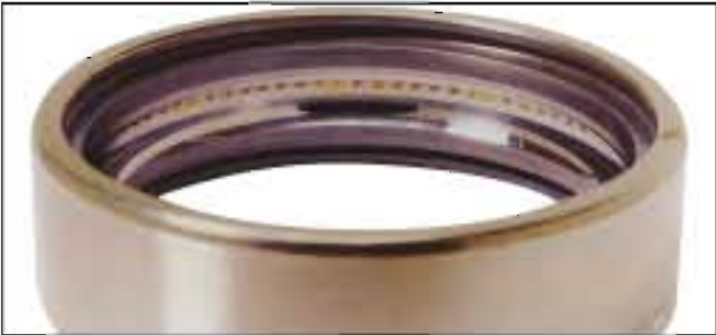
照片15-6 ●深沟球轴承的外圈。 ●滚道面上的条纹状电蚀（高频）。
