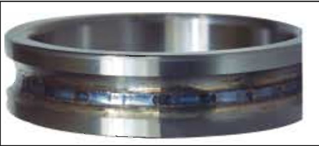
照片14-3 ● 角接触球轴承的内圈。 ● 滚道面变色，出现呈等球距分布的熔融痕迹。 ● 预紧过大造成的损伤。
