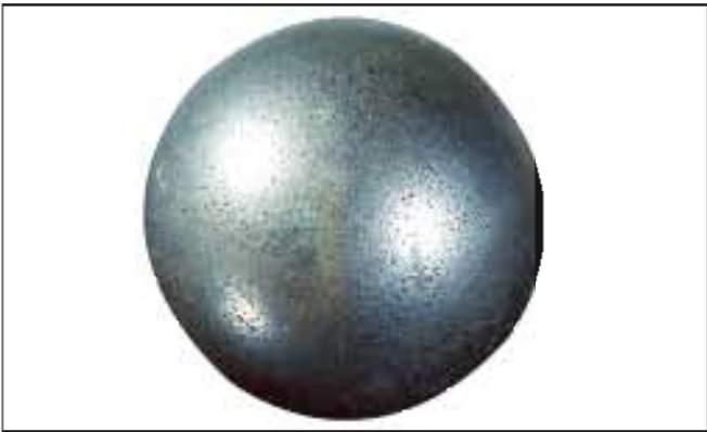
照片9-2 ● 照片9-1的钢球。 ● 滚动面呈现梨皮状
