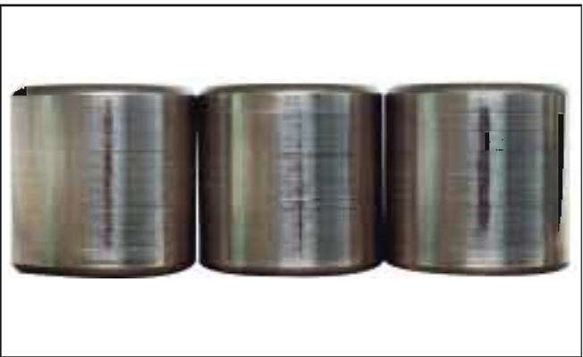
照片12-4 ● 圆柱滚子轴承的滚子。 ● 滚动面上的伪布氏压痕。 ● 停机时由外部振动造成的损伤。
