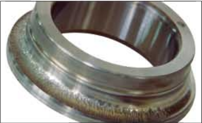
照片1-1 ● 角接触球轴承的内圈。 ● 沟道面半周产生剥落。 ● 原因是由于切削液侵入造成的润滑不良。
