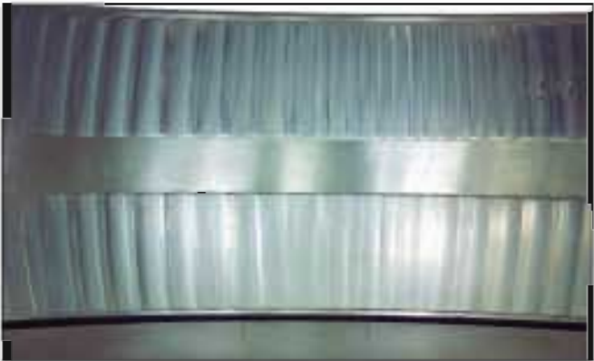
照片10-2 ● 调心滚子轴承外圈。 ● 承载区滚道面上凹凸不平的波纹状磨损。 ● 静止状态下反复振动，由异物侵入而造成的损伤。
