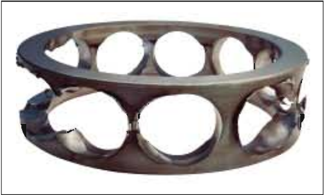
照片7-2 ● 角接触球轴承的保持架。 ● 铸铁车制保持架梁折断。 ● 原因是内外圈的安装倾斜。 ● 使保持架承受异常载荷。
