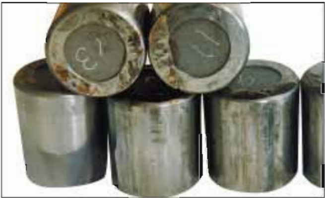
照片10-4 ● 照片10-3的圆锥滚子。 ● 滚子大端面上的阶梯状磨损。 ● 静止状态下承受过大载荷，由微动磨损发展而成的损伤。
