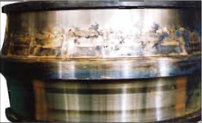
照片14-1 ● 调心滚子轴承的内圈。 ● 滚道面变色，保持架磨损粉末熔融后被碾轧，附着。 ● 润滑不良造成的损伤。
