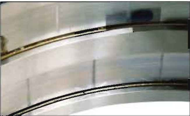
照片11-3 ● 双列圆柱滚子轴承的外圈。 ● 滚道面上按滚子间距分布的微动磨损。
