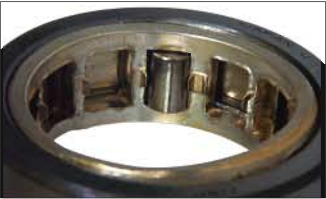
照片7-7 ●圆柱滚子轴承的保持架。 ●高强度黄铜车制保持架梁的磨损与变形。
