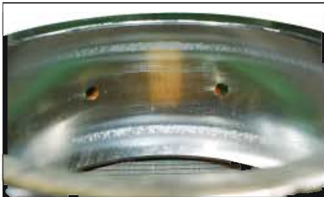
照片2-4 ●调心滚子轴承的内圈。 ●滚道面上下整圈产生的剥皮。 ●润滑不良造成的损伤。
