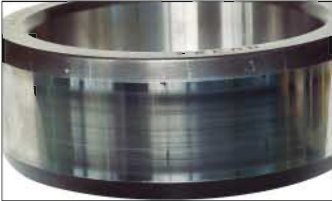
照片17-1 ● 圆柱滚子轴承的内圈。 ● 滚道面上的轴向伤痕。 ● 安装时内、外圈倾斜造成的。
