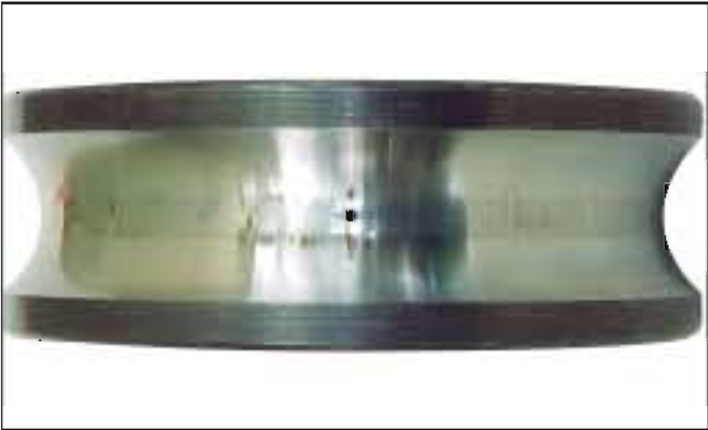
照片12-1 ● 深沟球轴承的内圈。 ● 滚道面上的伪布氏压痕。 ● 停机时由外部振动造成的损伤。
