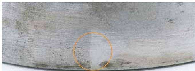
分体式轴承座结合处造成的轴承外圈应力集中点上的**局部剥落**。
