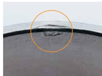
**轴承外圈——端面凹痕:**
