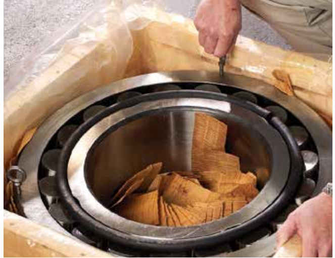
图2. 吊环螺栓可以拧入吊装孔中
