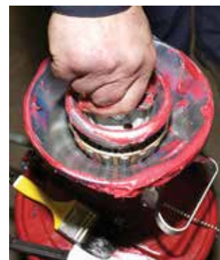
图 59. 机械润滑脂填充机
