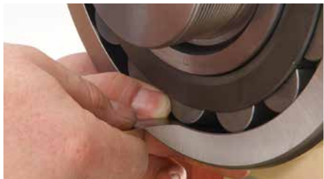
图 31. 安装过程中，检查无载荷滚子的 RIC
