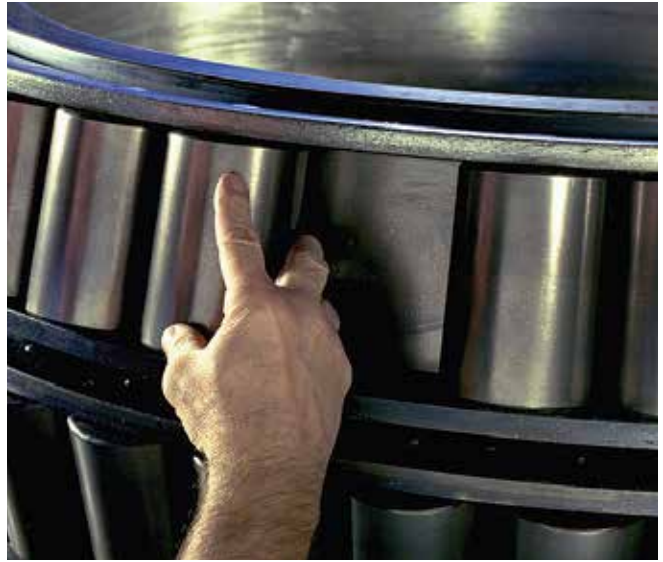
图 20. 在返回使用前必须检查轴承
