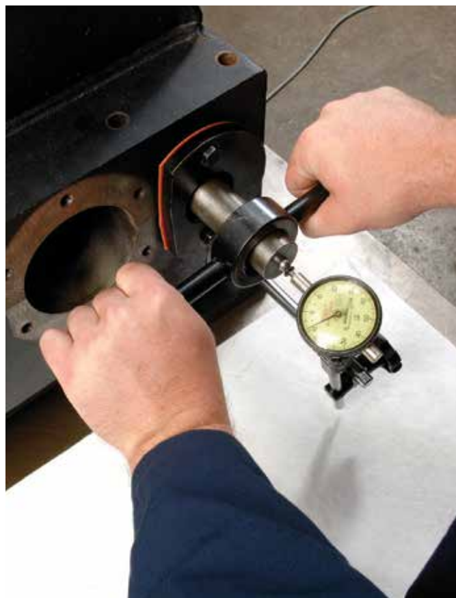
图 27. 在轴端装上百分表测量轴向窜动
