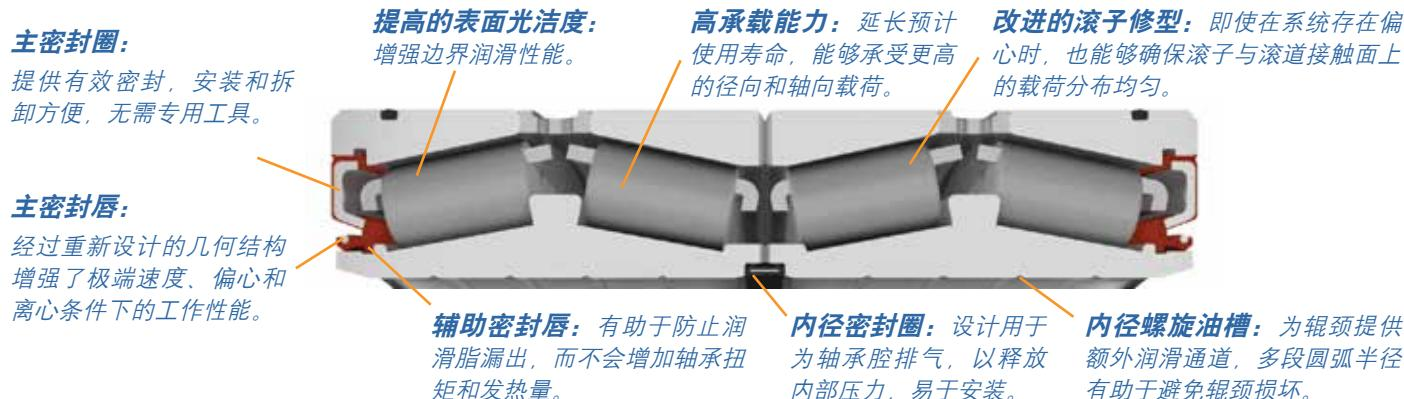
可选特征：中间双外圈；无润滑油槽及油孔的外圈隔圈；预润滑组件。
