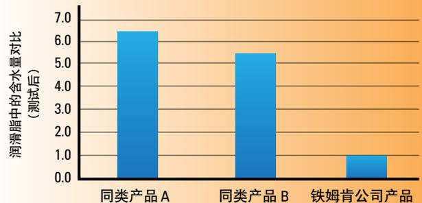
以上数据为动态实验室测试中模拟轧机工作条件的统计结果，实际情况可能有所差异。
