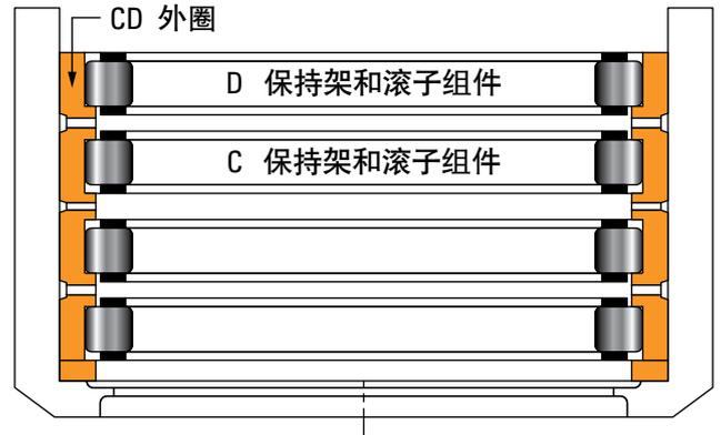
5. 将D法兰圈安装到轴承座内。
