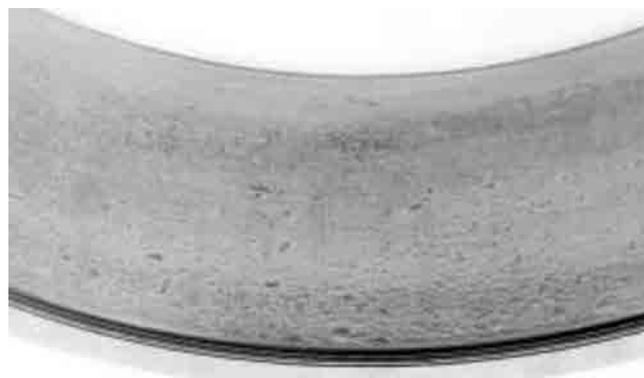
图160. 磨粒造成的轴承损坏
