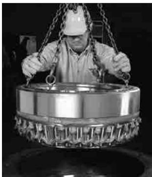
图246. 将润滑脂润滑过的部件安装到轴承座中
