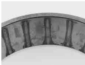
图189. 无点蚀的污点
