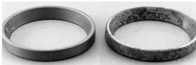
测试后的 AquaSpexx® 外圈      测试后的无涂层外圈
