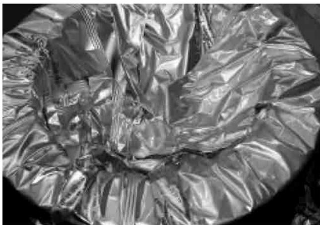
图194. 用于大轴承的真空热密封铝箔袋
