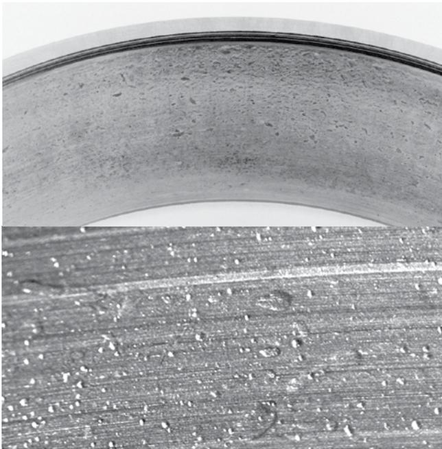
图178. 碎屑对轴承滚道造成的损坏
