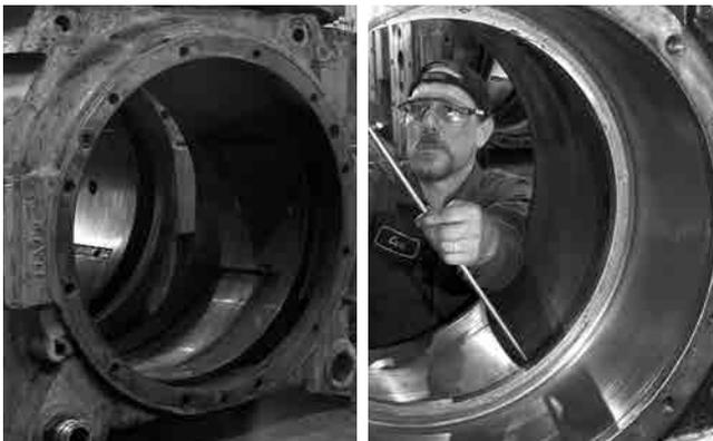
图278. 轴承座维护前后的对比照片
