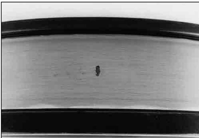
图169. 夹杂物源剥落
