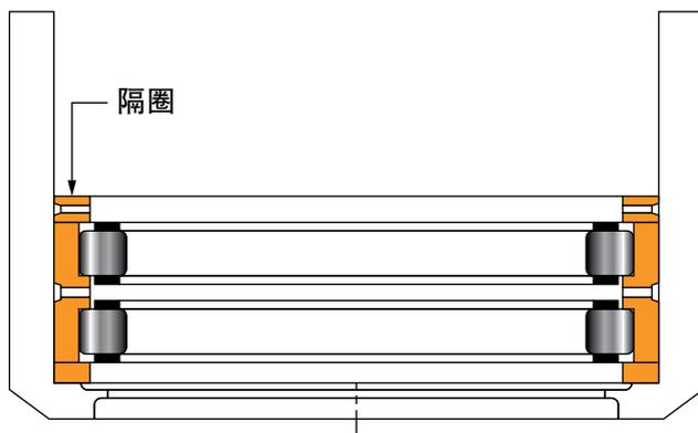
4. 安装CD外圈，使C和D保持架以及滚子组与正确的滚道匹配。
