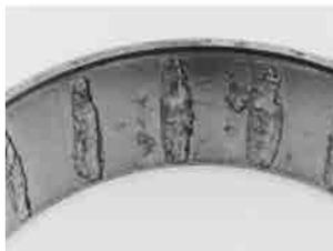
图191. 外圈滚道腐蚀
