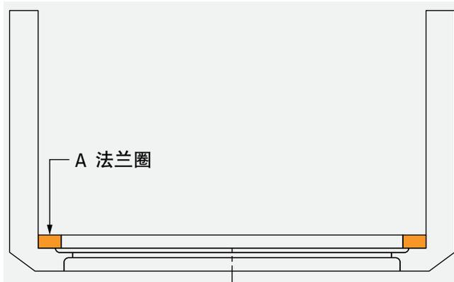
2. 安装AB外圈，使A和B保持架以及滚子组件与内圈滚道匹配。
