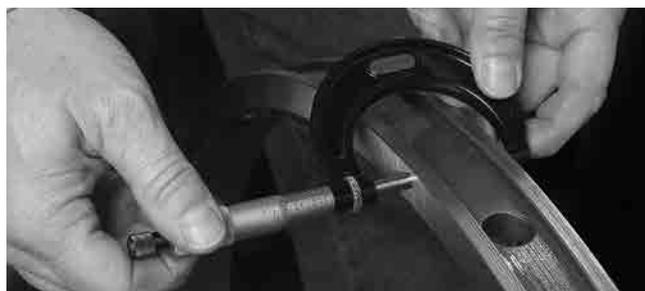
图269. 测量隔圈宽度
