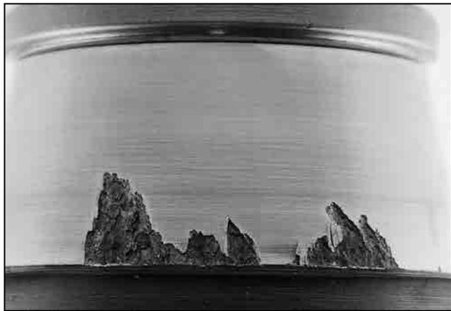
图171. 几何应力集中剥落
