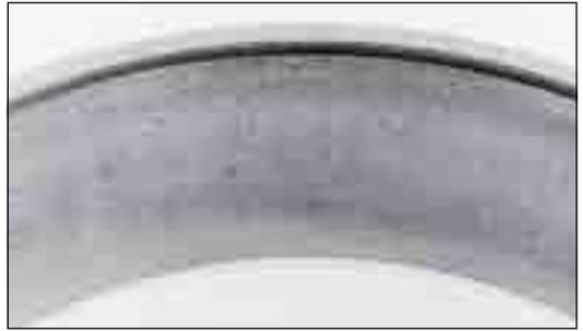
图 181. 由其他疲劳零件、密封松动或维护不当所产生的碎屑导致圆锥滚子轴承的滚道擦伤。
