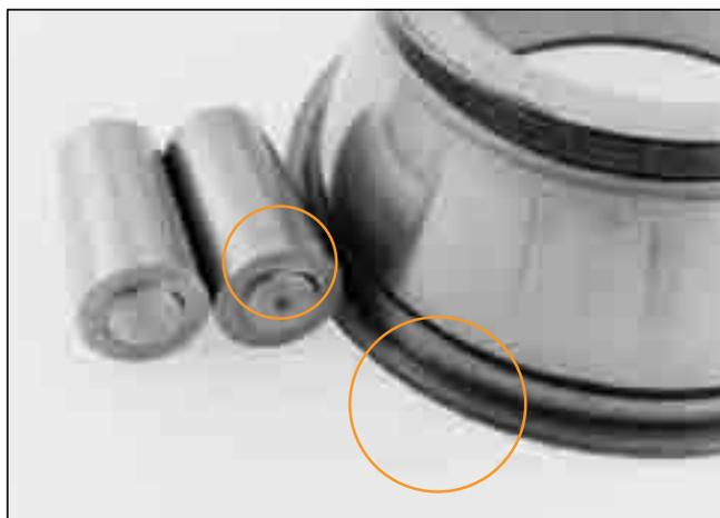
图 177. 微粒污染物造成圆锥滚子轴承磨损。
