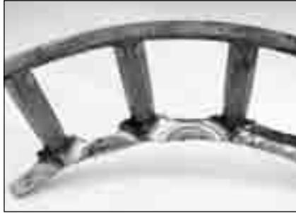
图 207. 滚子过度运动导致保持架兜孔损伤。
