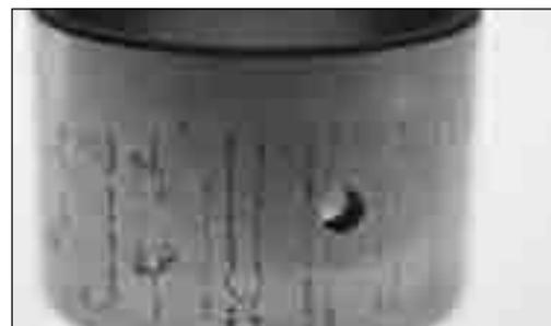
图 187. 圆柱滚子轴承的内圈出现浸蚀和腐蚀现象。
