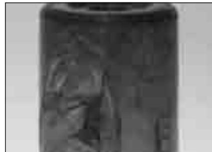
图 202. 由于过载，该圆柱滚子轴承的滚子表面出现开裂。
