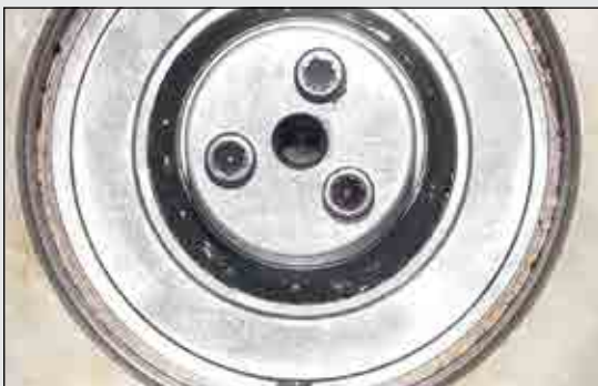
图 66. 通常在初次运行时, 从轴承上泄漏少量的“干净”润滑脂是可接受的。此时的润滑脂是湿的且泄漏得很均匀。如果少量的泄漏未引起任何问题, 则不用做任何处理, 因为它有效的屏障密封。
