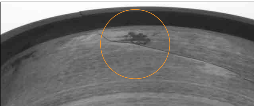
图 52. 由于安装在金属杂质或拱起的金属刻痕上，球轴承的内圈发生破裂。
