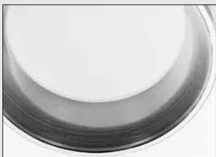
图 36. 变形，加工不精确或者磨损的轴承贴合面导致这个圆锥轴承外圈滚道上不规则的滚子磨损痕迹。
