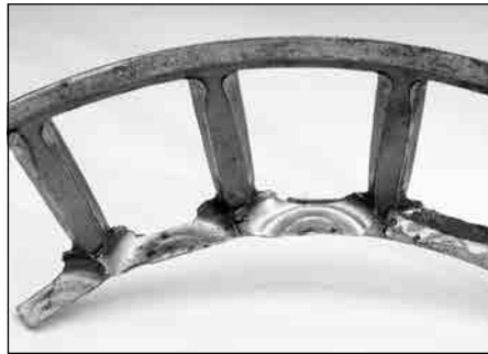
图 33. 滚子过度运动导致保持架兜孔损伤。
