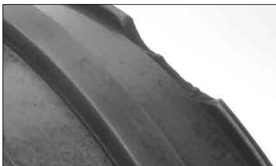
图 40. 由于使用了不合适的安装工具，调心滚子轴承内圈上的法兰出现破损。
