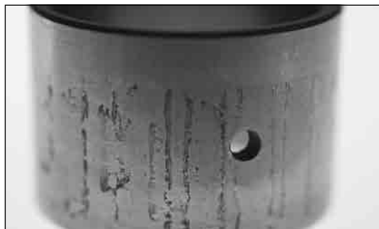
图 13. 圆柱滚子轴承的内圈出现浸蚀和腐蚀现象。
