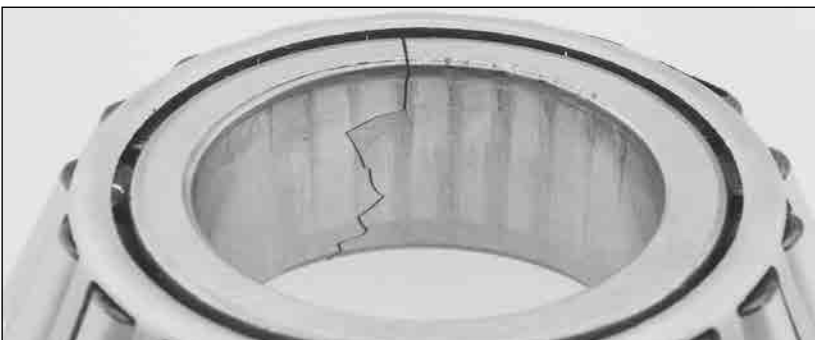
图 53. 失圆或轴径过大导致圆锥滚子轴承的内圈发生破裂。
