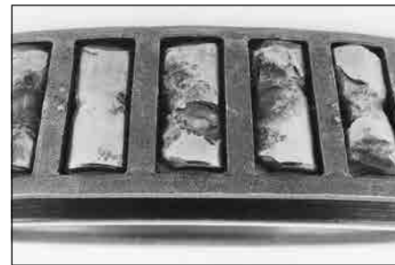
图 30. 圆锥滚子轴承的严重过载导致滚子出现过早的严重疲劳剥落。负荷过重，使滚子上的金属大片脱落。
