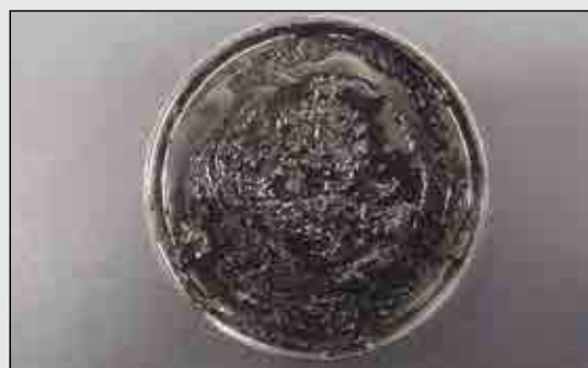
图 65. 该皮氏培养皿内盛有严重氧化的润滑脂, 是从注油过量的轴承上泄漏下来的。严重氧化的润滑脂通常呈现出明显的黑色, 并散发出焦臭味; 此外, 还会变硬。
