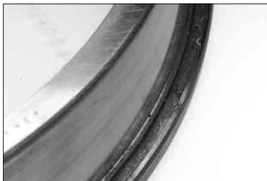
图 19. 二级-不足的润滑油膜导致严重的挡边擦伤。
