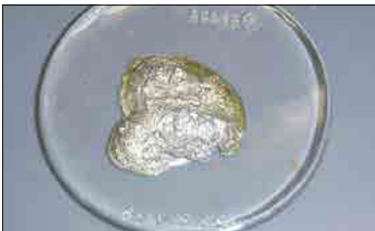
图 67. 含有发亮的轴承金属杂质的润滑脂, 取自注油不足的轴承。
