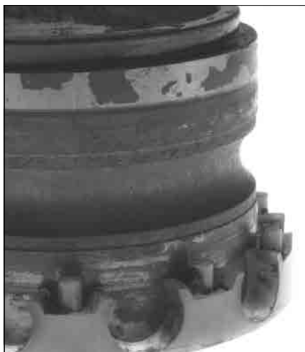
图 15. 球轴承的内圈和保持架被水严重腐蚀。
