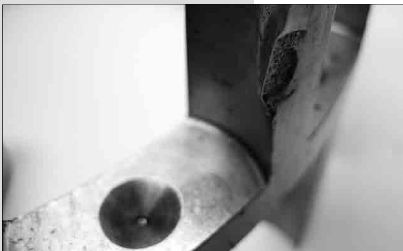
图 45. 操作严重不当使该调心滚子轴承保持架的梁上产生深度压痕。该损伤将导致滚子滚动不畅并出现打滑，温度升高，使用寿命缩短。
