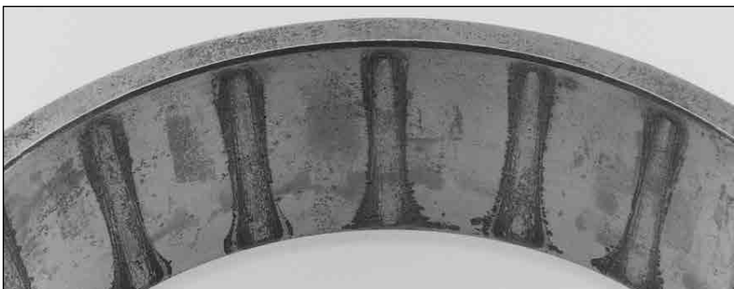
图 12. 图中外圈滚道呈现严重腐蚀。这种类型的腐蚀可能只是表面锈斑，而非点蚀。如果用细金刚砂布或磨粉布可以将污点清理干净，则轴承可再次使用。但如果存在麻点，而且用轻度抛光也清除不掉，则应当弃用；或者如果可行，将其重新打磨。
