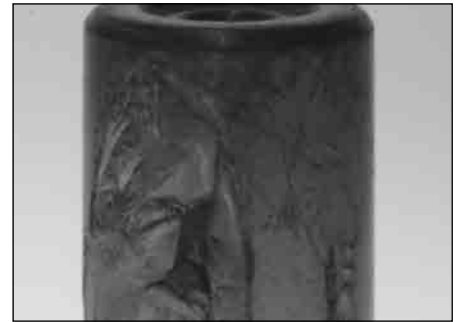
图 28. 由于过载，该圆柱滚子轴承的滚子表面出现开裂。
