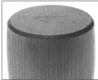
图 61. 轴承旋转时，因焊接而在调心滚子轴承上造成的电弧凹槽。
