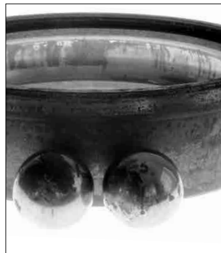
图 16. 球轴承的外滚道呈现出浸蚀和腐蚀。
