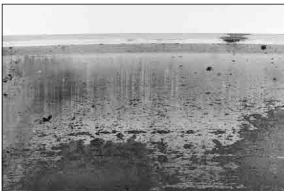
图 18. 二级-重载、低速或是骤升的工作温度使油膜过薄导致微剥落。
