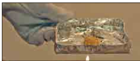
图 78. 灼烧测试可鉴定出润滑脂的含水情况。
