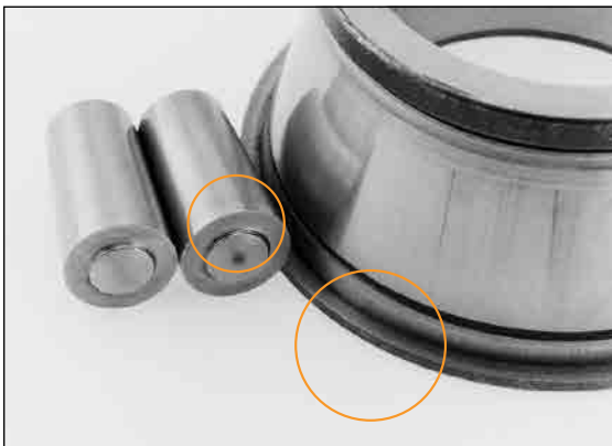
图 3. 微粒污染物造成圆锥滚子轴承磨损。
