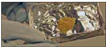
图 77. 进行灼烧测试时，首先将润滑脂样本置于一块铝箔上。
