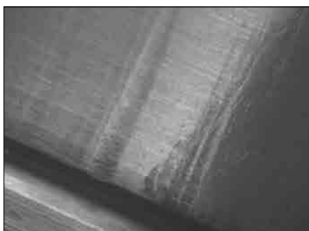
图 56. 调心滚子轴承内圈因冲击载荷产生的滚子冲击伤。
