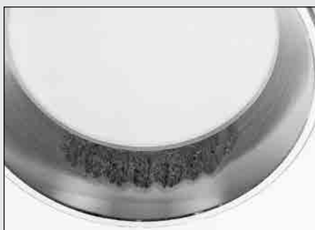
图 37. 这个不规则的滚子痕迹和图 36 的正好 180 度方向相对应。
