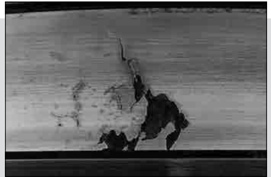
图 24. 圆锥滚子轴承内圈因碎片或凸起的金属超出了润滑油膜，引起表面凸物因素剥落。
