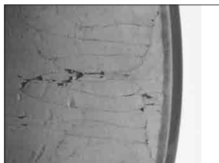
图 58. 因应用选型不当，圆柱滚子轴承的内圈在运转中碎裂。
