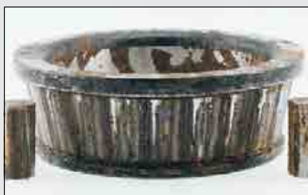
图 75. 与湿气/水份的接触使圆锥滚子轴承和球轴承的外圈和球（如图76）出现点蚀和腐蚀而生锈。该状况称为浸蚀。
