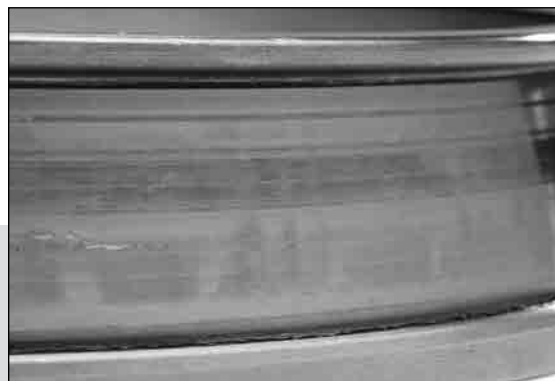
图 17. 一级-骤升的工作温度导致变色。
