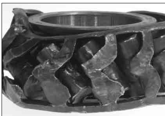
图 22. 四级—整个轴承锁死的例子。
