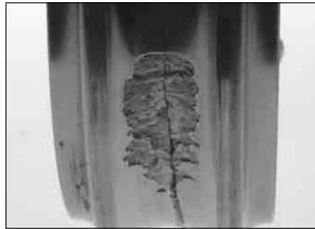
图 27. 球轴承的内圈出现了疲劳剥落。其断裂形式属于二级损伤。
