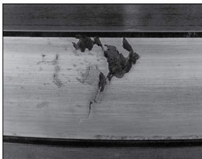
图 5. 因碎屑污染物擦伤发生表面剥落的圆锥滚子轴承内滚道（内圈）。
