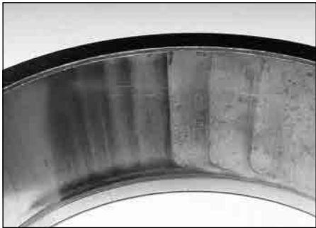
图 32. 游隙过大时经常会在外圈滚道上发现贝壳纹。这是由于松动的滚子进入小的负载区时突然承受巨大载荷造成的。
