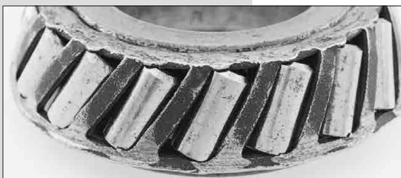
图 44. 圆锥滚子受卡成歪斜状，原因是在安装过程中保持架受到挤压，或是运行中有干涉。
