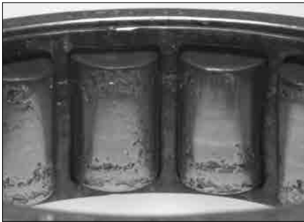
图 26. 高负荷导致该圆柱滚子轴承疲劳剥落。
