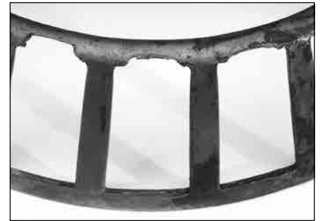
图 34. 保持架兜孔小端过度磨损是典型的游隙过大的标志。
