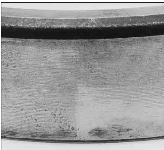
图 48. 外圈外圆上的伤痕是由轴承座上的凸点引起的。与此外圈外圆上伤痕对应的外圈内滚道，在此处发生了剥落。
