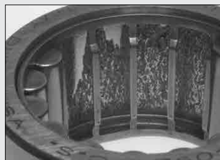
图 38. 轴承座内孔加工锥度不当，导致这个圆柱滚子轴承外圈的载荷分布不均，造成了GSC剥落。
