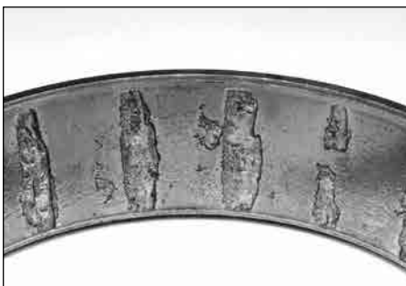
图 14. 由于内圈滚道和滚子受到高度腐蚀和点蚀，该轴承不能再使用了。
