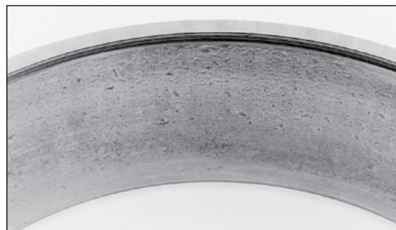
图 7. 由其他疲劳零件、密封松动或维护不当所产生的碎屑导致圆锥滚子轴承的滚道擦伤。
