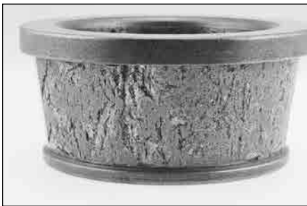
图 29. 重载，低速导致圆锥滚子轴承内圈上的润滑油膜不足。
