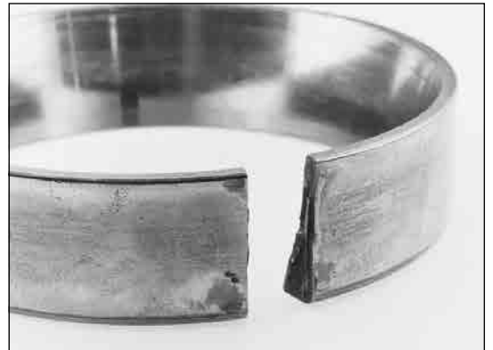
图 51. 这就是在轮毂里发生松动的外圈。外圈转动使轴承座磨损产生更大的间隙，外圈开始拉伸或铺开，此时仍然继续磨损轴承座，外圈继续拉伸，这个过程一直持续直到达到金属的断裂极限从而外圈裂开。
