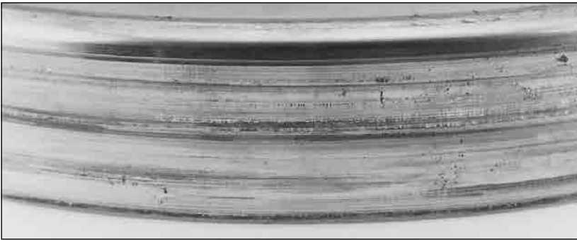
图 50. 旋转轮毂的外圈采取松配合（应该是紧配合），结果使轴承滚道损伤。
