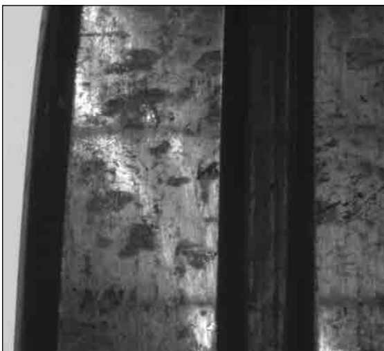
图 46. 由于轴承座磨损，导致该轴承在运行过程中配合松动，产生磨损。结果调心滚子轴承外圈出现金属撕裂和磨损。
