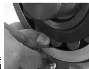
图 15. 在安装过程中，应检查未承载滚子处的径向游隙
