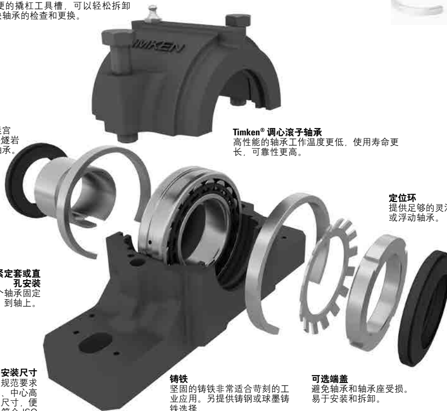
图 25. SNT 带座轴承组件和功能
