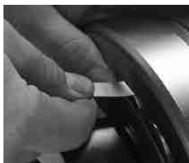
图 14. 在轴承安装之前测量径向游隙
