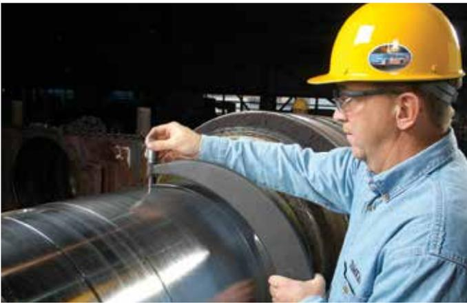
图41 安装轴承前，检查轧辊颈尺寸
