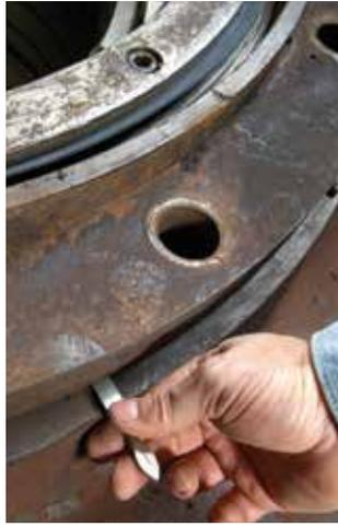
图40 使用塞规确保外圈被适当夹紧
