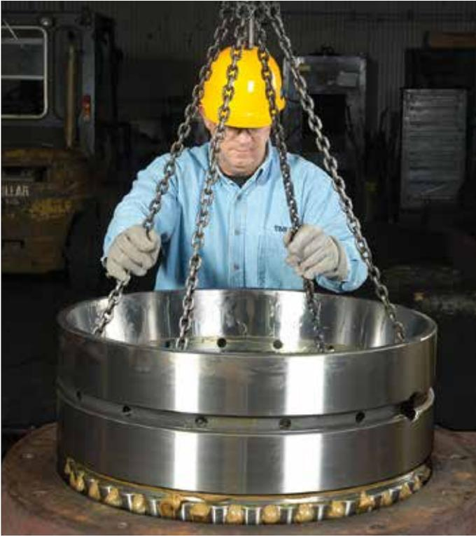
图 36 将底部双内圈和双外圈装入轴承座
