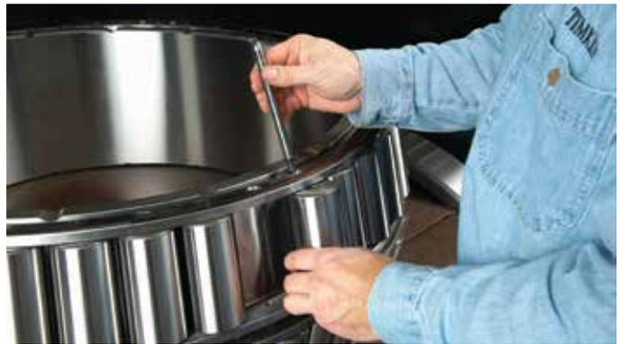
图12 取出滚子，检查内圈外径或滚道
