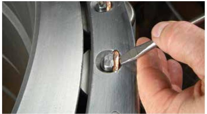
图11 移去柱销上的安全锁紧丝
