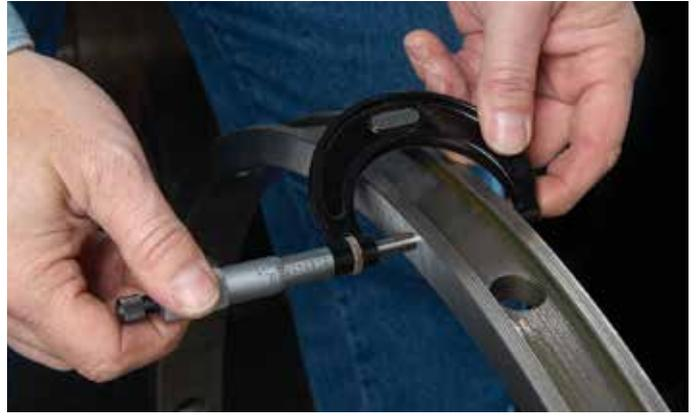
图20 测量B、D和C隔圈宽度
