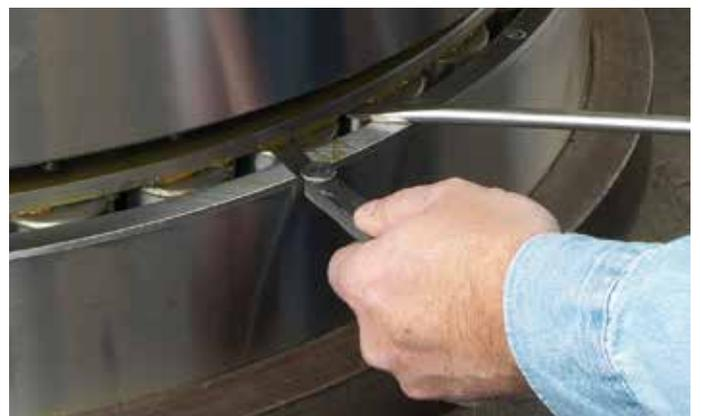
图18 使用塞规检测轴承部件的贴合情况
