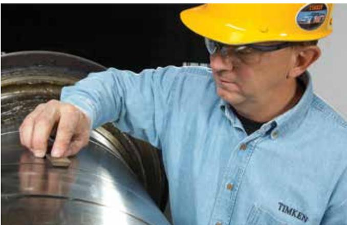
图42 去除轧辊颈上的所有刻痕
