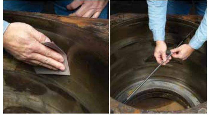
图23 除去轴承座上较严重的锈蚀或微磨损剥落
