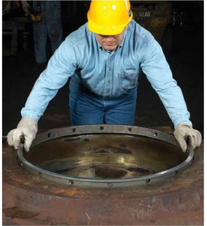
图34 安装外圈隔圈
