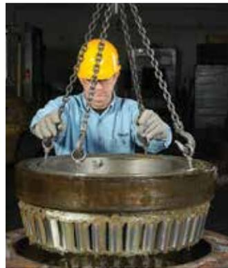
图8 取出顶部单外圈和顶部双内圈
