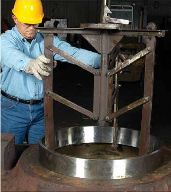
图33 将底部外圈装入轴承座
