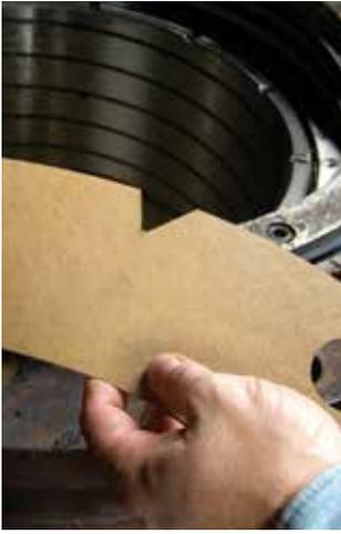
图39 在垫片上剪出V形切口
