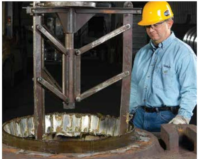
图10 取出底部单外圈和底部外圈隔圈
