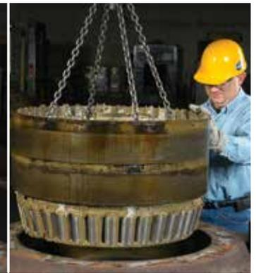
图9 取出双外圈、底部双内圈、内圈隔圈和顶部外圈隔圈
