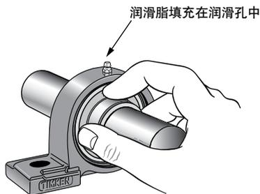
3. 使用尺寸合适的紧固件和推荐的螺栓扭矩（请参阅第 12 页表 5）将轴承座紧固在安装底座上。安装任何一种带座轴承单元时都应使用平垫圈。根据螺栓直径选择合适尺寸的垫圈。
