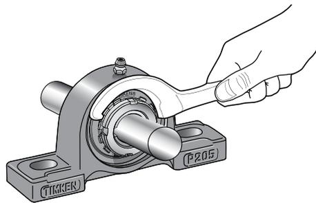
7. 将防松垫圈舌片弯入锁紧螺母槽中，以防止锁紧螺母松脱。
