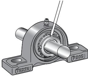
8. 紧固安装螺栓的同时用手转动轴，确保轴可以自由转动。将带座轴承单元的安装螺栓紧固至第 12 页表 5 中给出的推荐扭矩。
