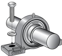
4. 均匀拧紧每个内圈定位螺钉至推荐的扭矩水平（参见第 12 页表 4），从而将轴承锁紧在轴上。
