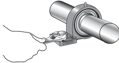
4. 将偏心锁紧套放置在轴上，使其凸轮靠近轴承内圈末端的凸轮。偏心轴环的凹处与轴承内圈的凸起端相接合。沿轴旋转方向转动轴环。
