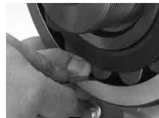
图 4. 在安装过程中, 应检查未负载滚子处的 RIC。
