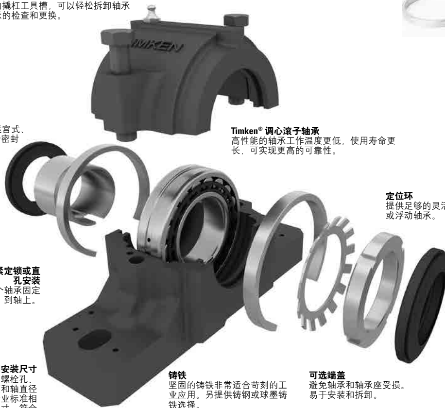
图 13. SNT 带座轴承组件和功能。
