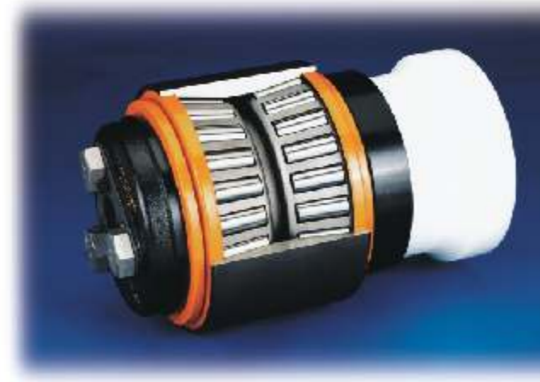
AP-2轴承轴颈更短，减小了轴的弯曲
