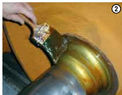
2. 安装轴承前，在轴肩圆角和防尘座至轮毂之间表面涂一层经认可的中重防锈涂层
