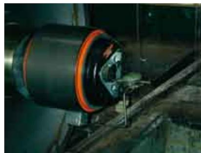
8. 利用安放在磁性座上的百分表来检查轴承的轴向游隙。边旋转轴承，边将轴承外圈推向轮毂侧。百分表放置的位置如图所示。向远离轮毂的方向拉拽轴承外圈。轴承轴向游隙应该是 0.001"-0.015" (0.0254mm-0.381mm)。如果用手能够自由旋转圆锥滚子轴承，但百分表显示的轴向游隙值小于 0.001" (0.0254mm) 此状态仍满足应用要求
