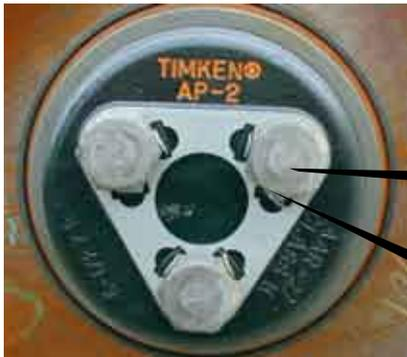
6. 安装前盖，用扭矩扳手拧紧螺栓至表格规定的扭矩。反复几次检查每个螺栓，直到达到设定扭矩时，每个螺栓都不转动为止
