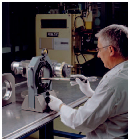
10: 将滚道直径传递到包络圆量规上
