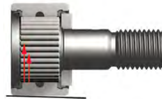
圆柱形外圈： 不对中可引起边缘载荷
